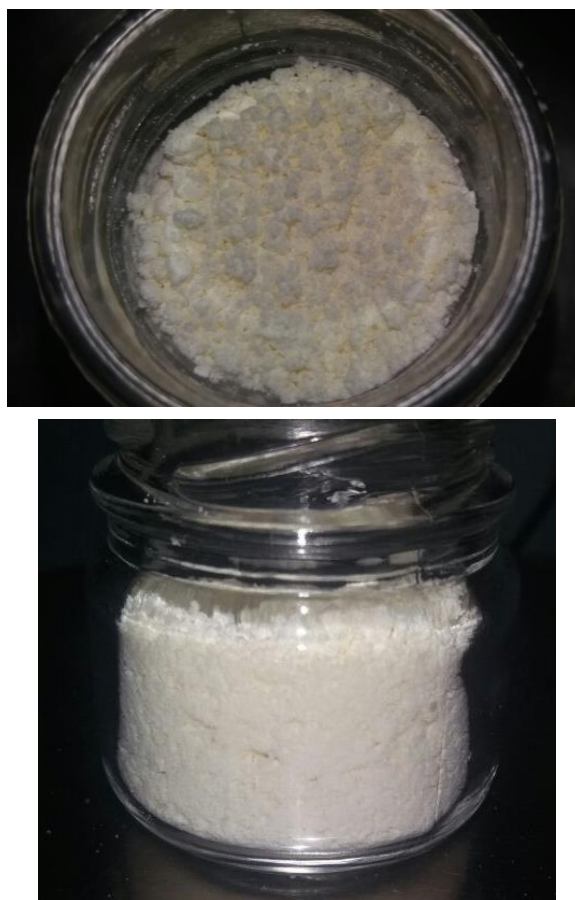
Figura 9. Requeijão probiótico em pó obtido pelo ensaio 5 (90 °C, vazão 0,4L/h, 1% de gelatina e 10% de maltodextrina 10 DE)
