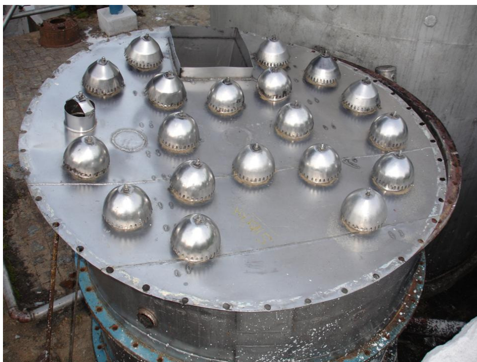
Figura 16B. Visão geral de um prato (bandeja) utilizado na coluna do fornecedor “F1”.
