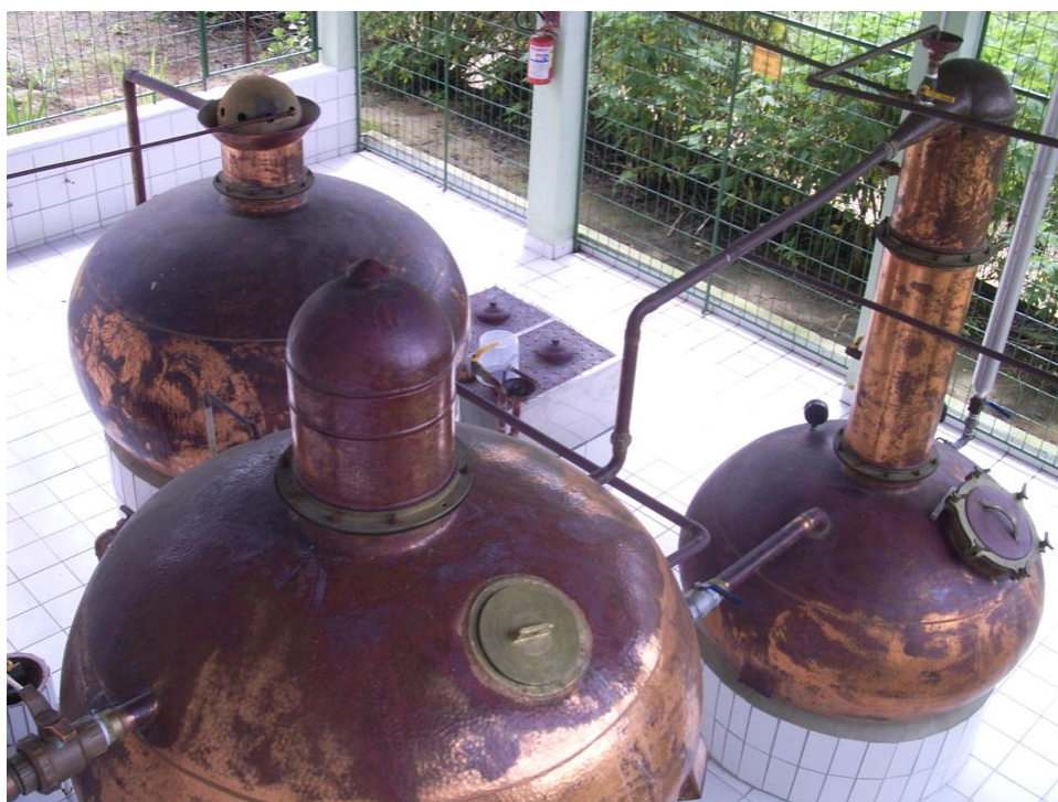
Figura 10B. Visão geral do alambique do estabelecimento “O”, mostrando um pré-aquecedor de cobre (esquerda, abaixo), panela de cobre (à direita) e serpentina de cobre (esquerda, acima).
