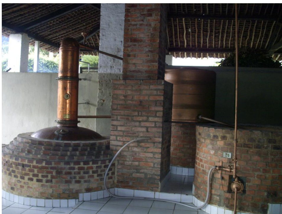
Figura 4B. Visão geral do alambique do estabelecimento “C”, mostrando um pré-aquecedor de vinho (centro, ao fundo), panela de cobre, coluna de cobre e alonga de aço (à esquerda) e serpentina de condensação de aço (à direita).
