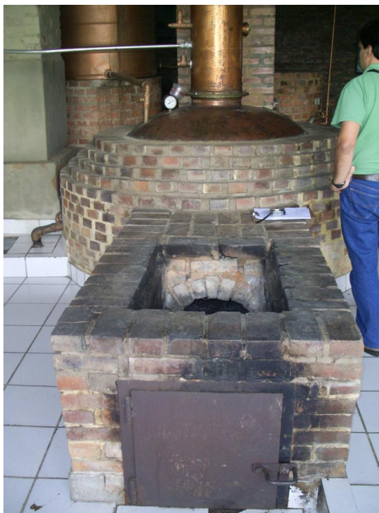
Figura 3B. Sistema de aquecimento (fogo direto) do estabelecimento “C”.
