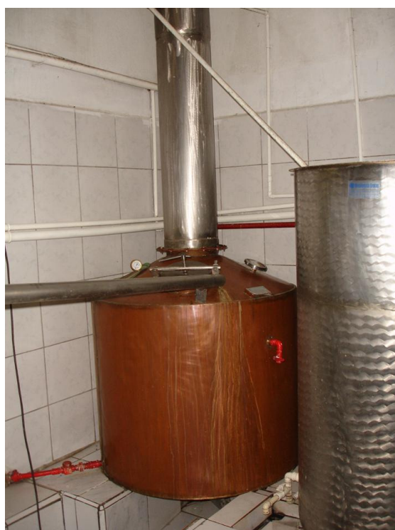
Figura 2B. Visão do alambique do estabelecimento “B”, mostrando panela de cobre e coluna de aço.
