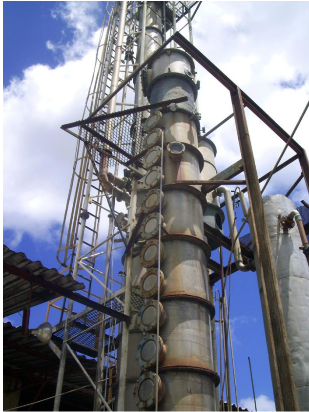
Figura 17B. Visão geral da coluna “1” do fornecedor “F2”, mostrando uma secção externa de cobre (topo).
