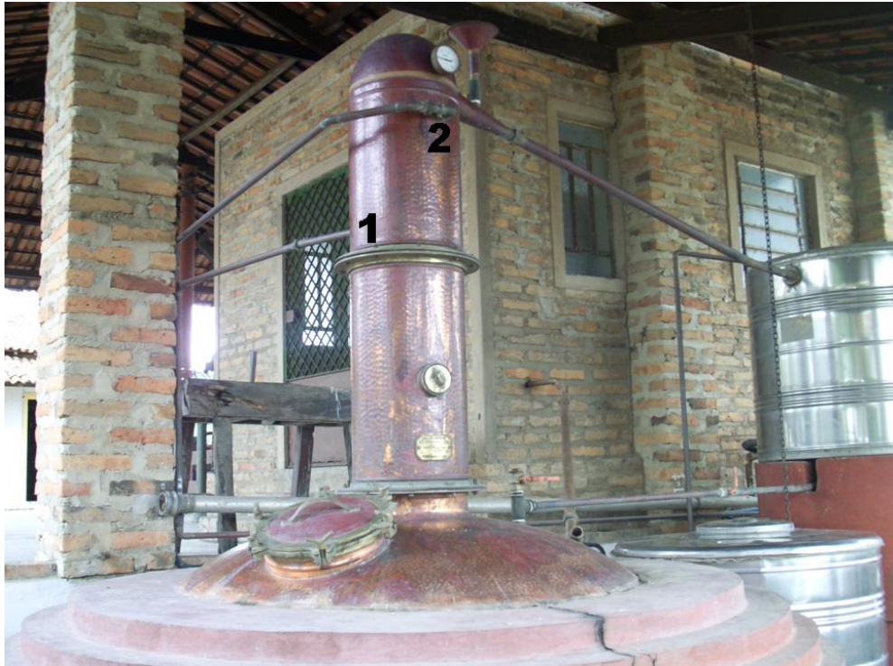
Figura 7B. Visão do alambique do estabelecimento “D”, todo fabricado em cobre, mostrando pré-aquecedor de vinho (direita, acima) e dispositivo de refluxo da coluna: (1) Entrada de água; (2) Saída de água.
