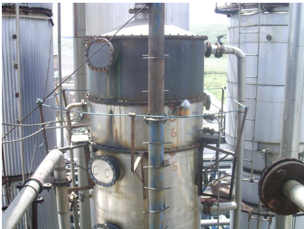
Figura 19B. Topo da coluna do fornecedor “F3”, mostrando uma secção externa de cobre.
