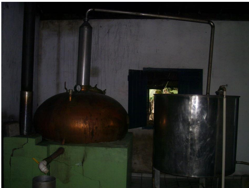
Figura 1B. Visão geral do alambique do estabelecimento “A”, mostrando panela de cobre e coluna de aço (à esquerda) e serpentina de aço (à direita).
