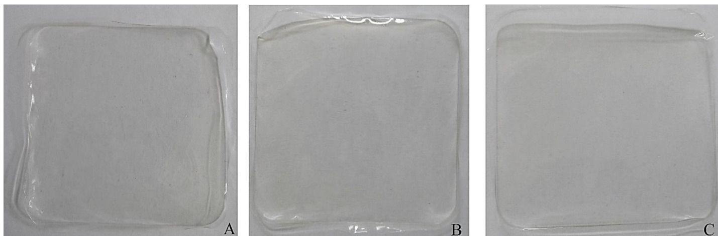
FIGURA 4: A) Filme de quitosana com 0% de extrato, B) Filme de quitosana com 1% de extrato, C) Filme de quitosana com 2,5% de extrato (v/m)
